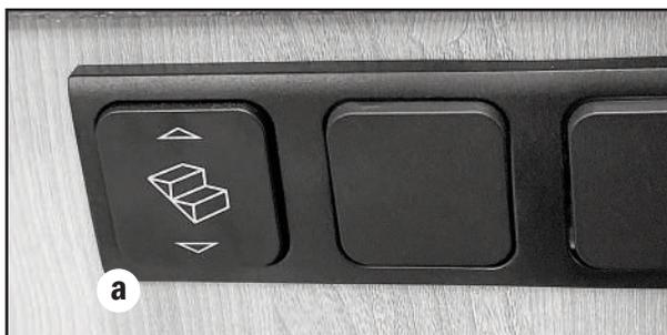
Il est possible d'activer l'ouverture et la fermeture du marchepied d'entrée au moyen d'un interrupteur (a) situé à l'intérieur du véhicule, près de la porte d'entrée de la cellule.
