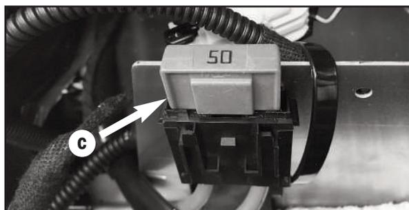
En cas de période d'inutilisation prolongée du véhicule, débrancher toujours la batterie cellule en enlevant le fusible (c), qui est situé dans la base du siège passager (à proximité de la batterie).
