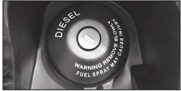
Le bouchon de remplissage de carburant est situé sur le côté gauche du véhicule, à proximité de la cabine de conduite, et est indiqué par l'inscription "DIESEL".
