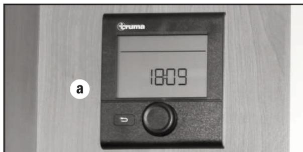
Toutes les fonctions du système peuvent être programmées à partir du tableau de contrôle Truma CP Plus (a). Pour la mise en fonction, la gestion et l'extinction ainsi que pour toutes les informations relatives à la maintenance et la sécurité, lire attentivement le guide d'utilisation du constructeur qui est fourni avec la documentation de bord.
